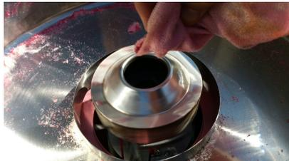
Die Spindel lässt sich nach dem Betrieb einfach mit einem feuchten Lappen säubern
